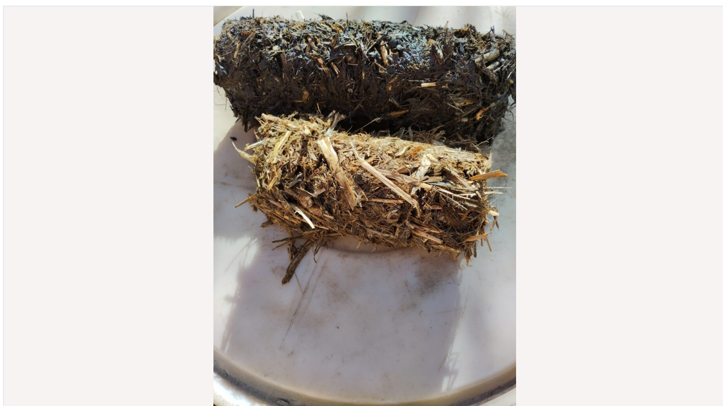
Briqueta de restos de cañas con y sin aglutinante — Foto: Moisés Evaristo Bueno
